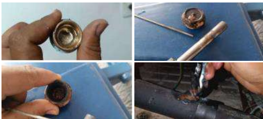
Realiza reparo com solda em prata e é instalado novamente na máquina cassete.
